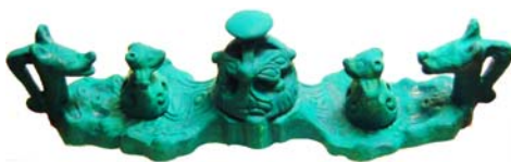
Fig. 3. Färdigt vax med rekonstruerade delar och uträdat bottenplatta – Redo för gjutning!
